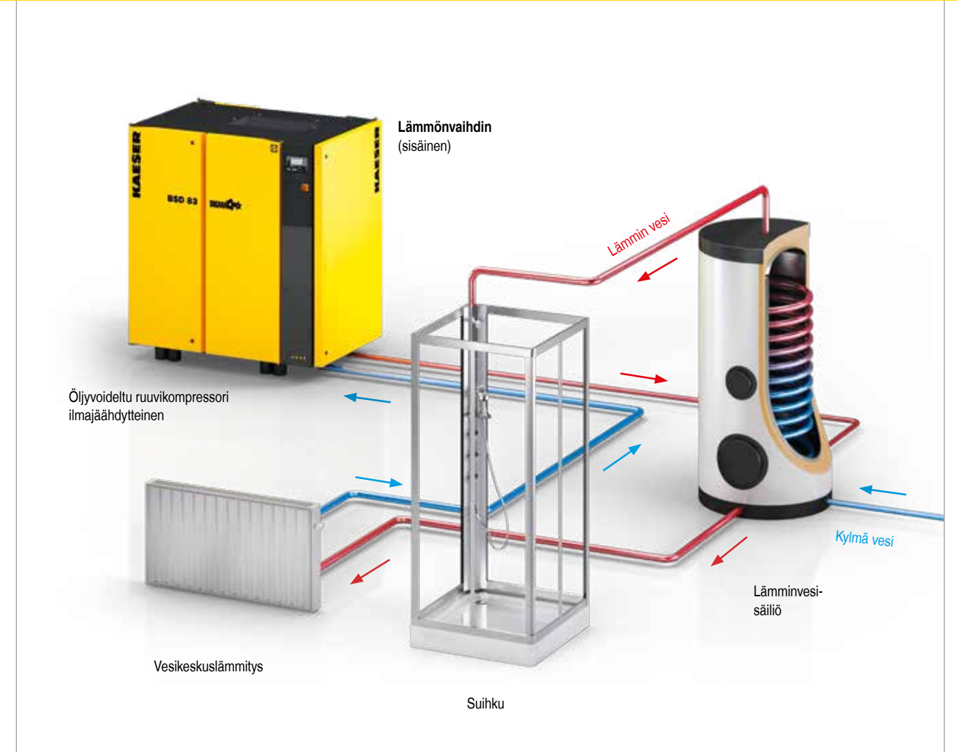
Kuva: Kaavio lämmön talteenotto; käyttö juomavetenä mahdollista vain erityisvarmennetun turvalämmönvaihtimen (SWT) kanssa
